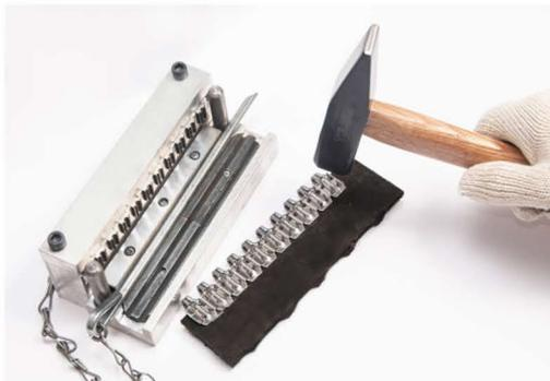
6 Con un martillo, terminar de doblar los dientes del remache de sujeción de Grampa Titan.
