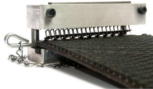
3 Colocar y centrar con la maquina Ferrart-AJF86, la tira de la grampa a igual distancia de los extremos con las grapas hacia arriba, procurando que se introduzca hasta el tope de correa de las grapas. Colocar la maquina con la barra de empuje levantada en el centro de la tira de grapas. Con precaución bajar la barra de empuje hasta que haga tope corroborando que las grapas ajusten la banda.
