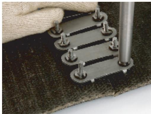
**8** Utilizando el Rompe-Tornillos Ferrart quebrar los pernos con un movimiento de balanceo paralelo al empalme.
