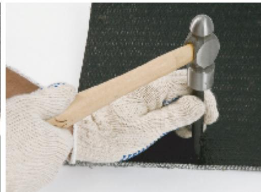
**1-A** Escuadrar la banda en ángulo recto usando el método de línea central. Corroborar que el extremo de la cinta este a 90° con respecto a sus bordes. Para bandas con cubierta superior de 3/16" (4-8 mm) o mas se recomienda devastarlas.
