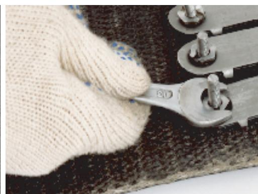
**3** Armar las placas colocando los tornillos en la cara de la placa del agujero con traba y retenerlos colocando el seguro de los mismos. Colocar las grampas semi-armadas en un extremo de la banda e introducir los tornillos desde abajo hacia arriba por los agujeros realizados
